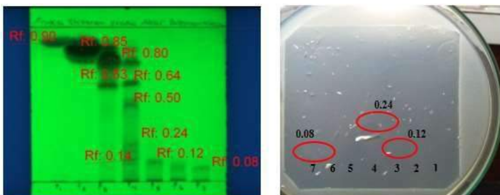
Gambar 4.13 KLT bioautogram kontak fraksi 1-7 hasil fraksinasi dengan kromatografi kolom terhadap E. coli dan dengan informasi nilai R_f di bawah sinar UV 254 nm.
